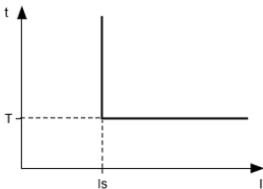
Rysunek 3.1 - Zasada działania zabezpieczenia zwłocznego niezależnego
